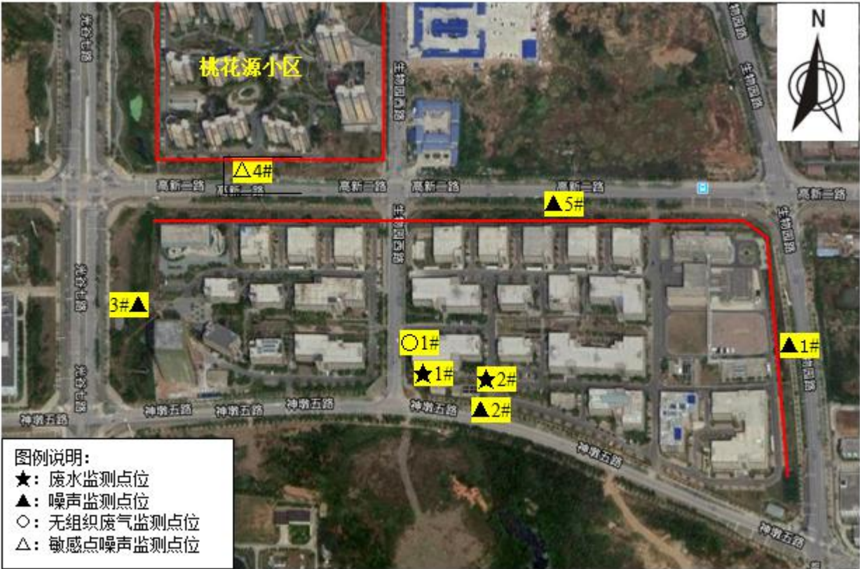
图 7-3-1 武汉光谷国际生物医药企业加速器建设项目验收监测点位示意图
